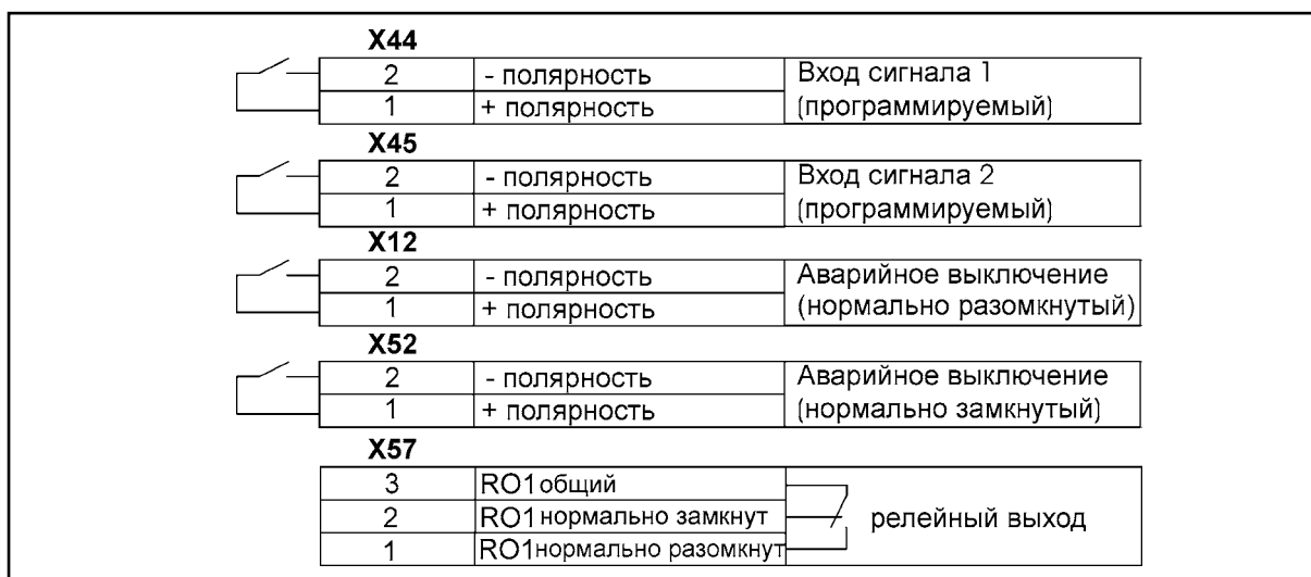
Рисунок 11 Подключение к ИБП кабелей внешних управляющих устройств.
