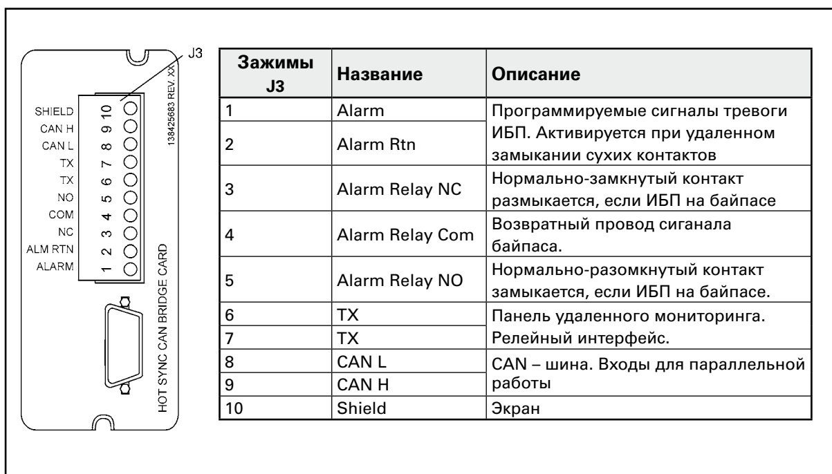
Рисунок 26 Адаптер XSlot Hot Sync и контактный интерфейс
