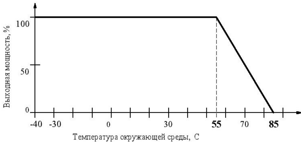
Рисунок Е.2 – Зависимость выходной мощности от температуры окружающей среды в условиях естественной конвекции (для К.П.Д. = 85 %)
